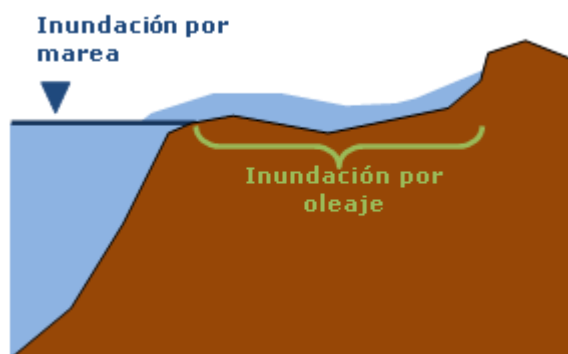
Figura 5. Esquema de inundación por marea e inundación por oleaje.
